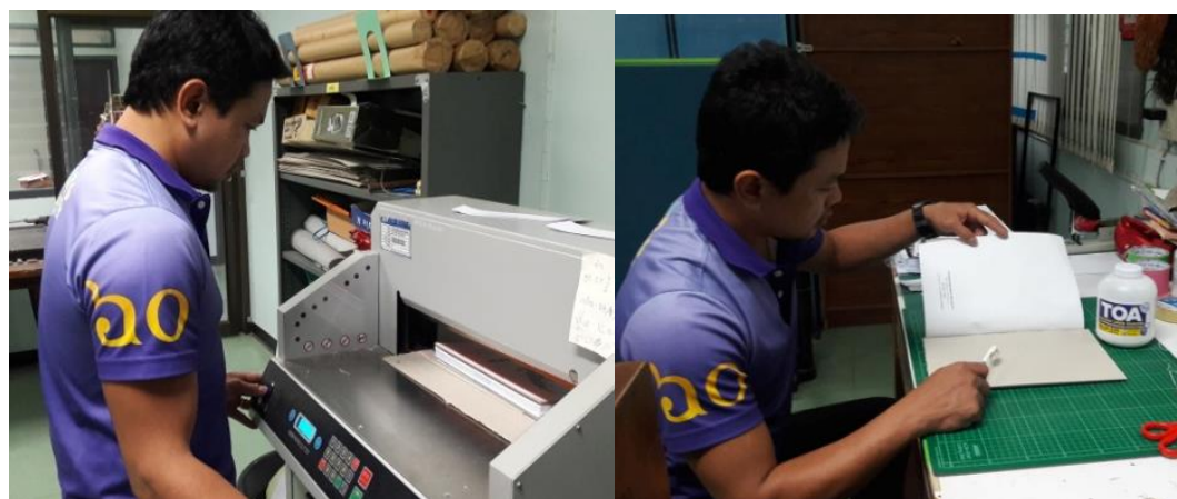
ภาพที่ 4.45 การตัดเล่มและเสริมปกด้วยกระดาษแข็ง
