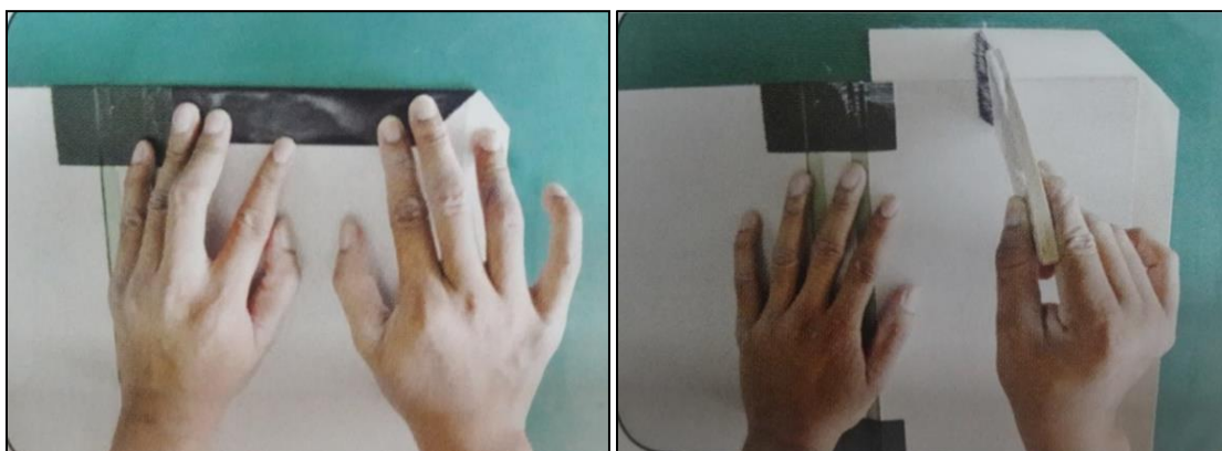
ภาพที่ 4.30 การหุ้มปกด้วยแลคซิ่น
